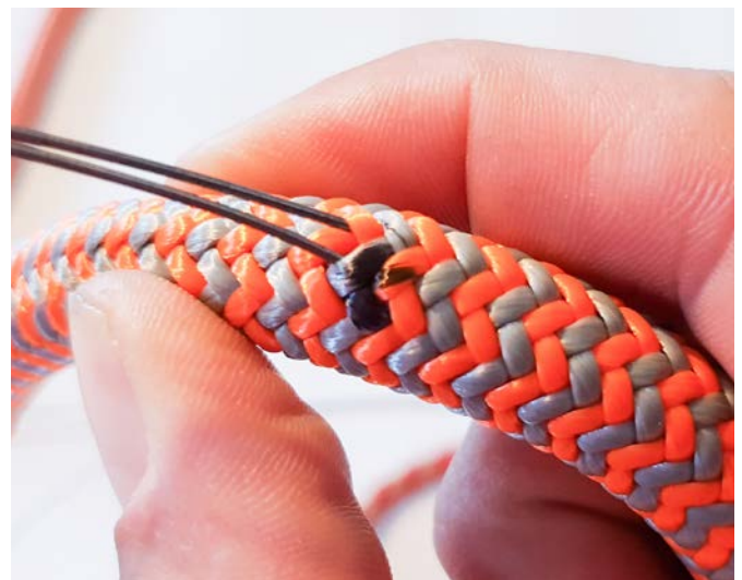
Spleißbahle/Spleißnadel (Draht) mit Schlinge am Ende Splicing needle (wire) with sling at the end
